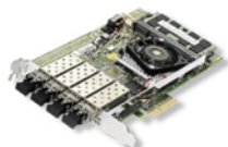
Адаптер D7 (PCI Express) для четырех линий 10/100 Мбит и 1 Гбит Ethernet (оптическая/электрическая)
